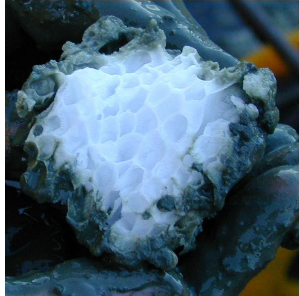
Gashydratblock mit wabenartiger Struktur vom „Hydrate Ridge“ vor Oregon, USA. Das Gashydrat wurde auf einer Forschungsreise mit dem deutschen Forschungsschiff FS SONNE aus etwa 1200 Metern Wassertiefe mit einem Schaufelgreifer aus dem obersten Meter des Sediments geborgen. Quelle: Wusel007 2009
