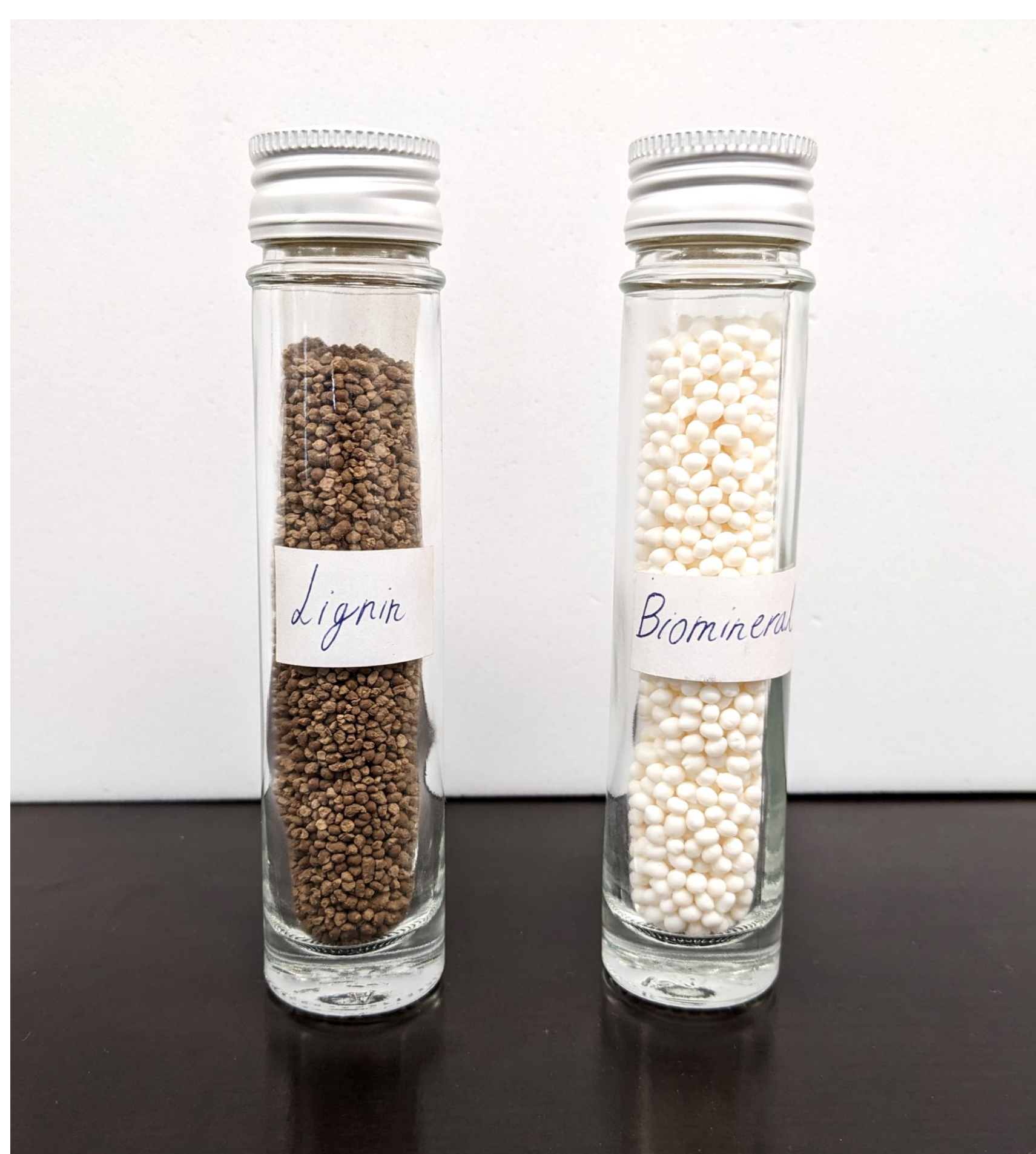
Abb. 2. Bioaerogel auf Basis von Lignin (links) und Silika - Biomaterial-Aerogel (rechts)
